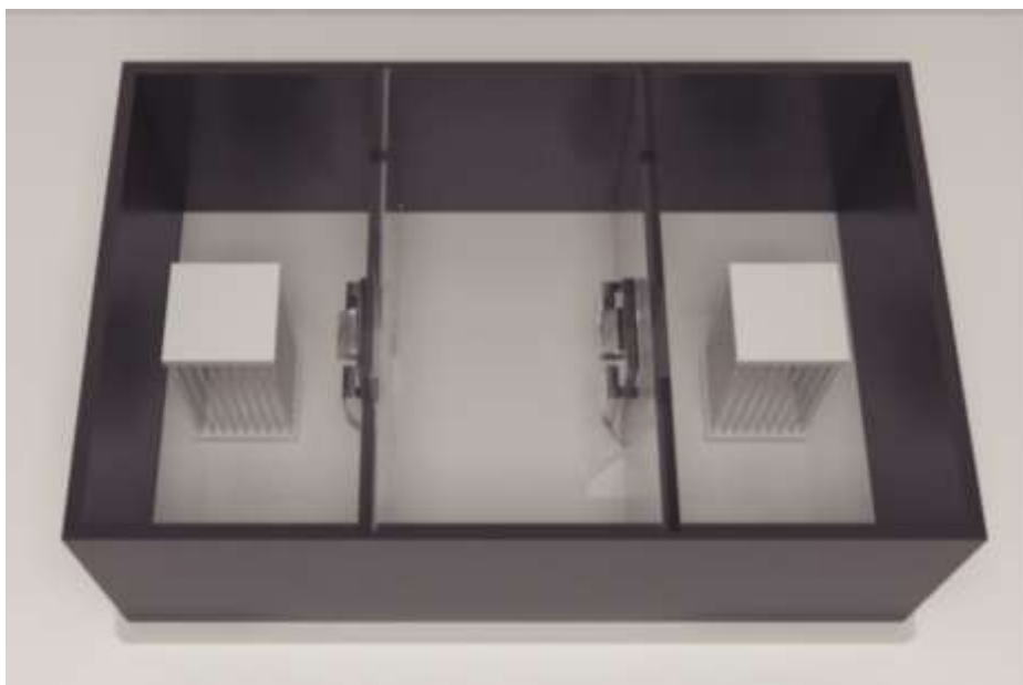
Рис. 2.5. Будова установки тесту «Перегородка», справа та зліва у бічних камерах розміщені клітки для не знайомих тестованому щурів. У першій сесії тесту одна з кліток залишається пустою та виступає у якості неживого об'єкта. (Maze basics 3 )
