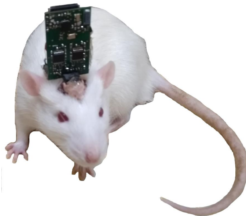
Рис. 2.5. Бездротовий пристрій для реєстрації електричної активності гіпокампа зафіксований на голові у щура.
