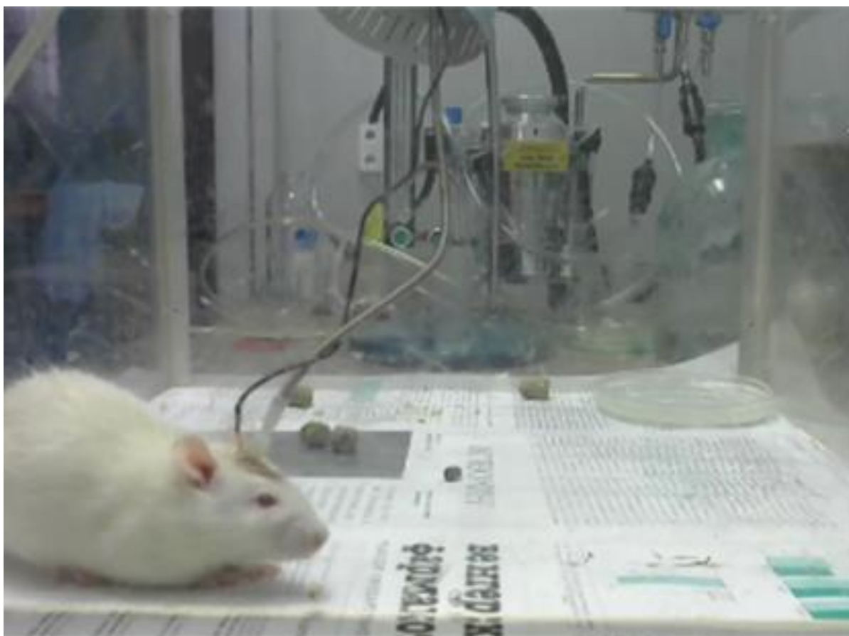
Рис. 2.2. Приклад класичної дротової системи реєстрації електроенцефалограми у щурів.
