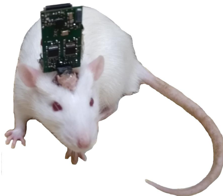
Рисунок 2.5. Бездротовий пристрій для реєстрації електричної активності гіпокампа зафіксований на голові у щура.
